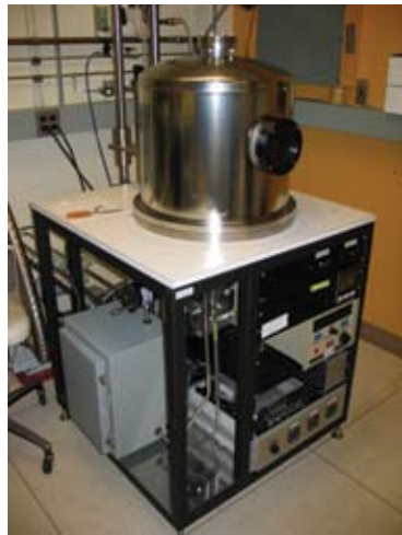
Figure 1: PECVD Machine for growing CNTs at MIT
